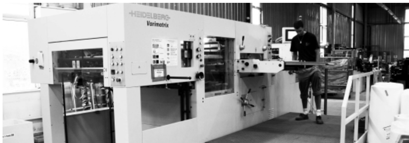
Varimatrix 105 d'Heidelberg pour la découpe et le gaufrage (Imprimerie des Deux Ponts)
